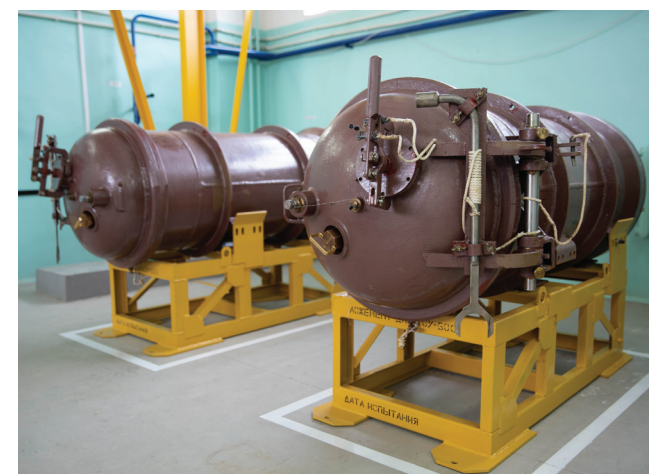
Контейнеры для хранения и автоматического выпуска спасательных плотов ПСНЛ-20М
