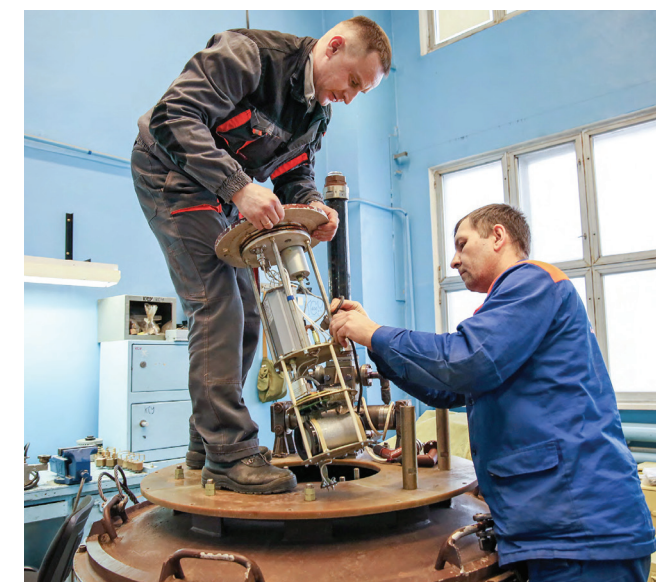
Техническое обслуживание аварийного радиобуя В-612
