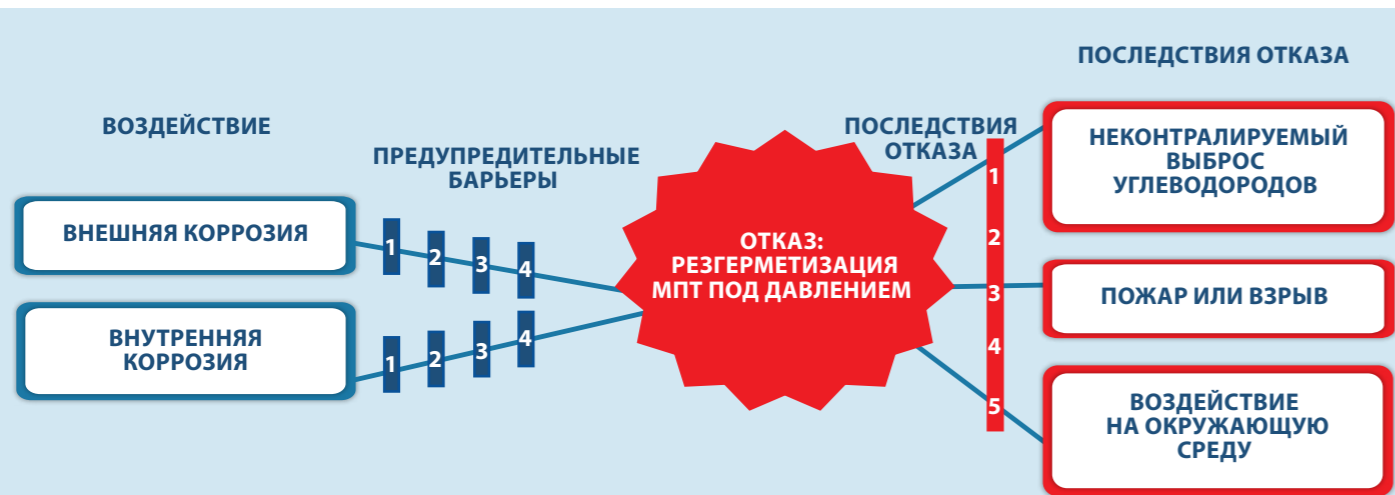
Рис. 1. Диаграмма «галстук-бабочка» для морских подводных трубопроводов при воздействии внешней и внутренней коррозии
