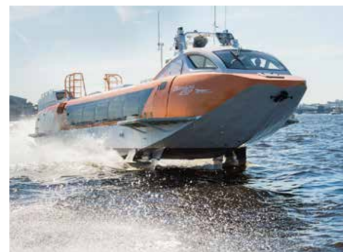
Речное мелкоякорное пассажирское судно на подводных крыльях «Валдай 45Р» проекта 23180. Предназначено для скоростных перевозок в светлое время суток. Оборудовано системами управления Иртыш 7СУ6-10.7 производства ООО ПЗ «РИАТОМ»
