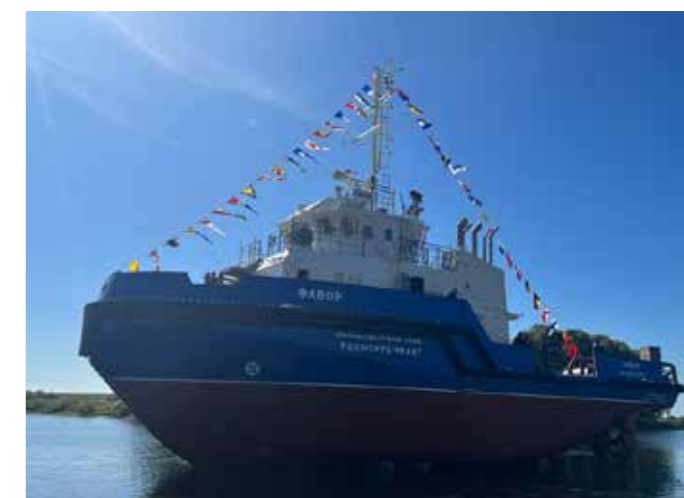
Буксир «Фавор» - пятый из пяти морских буксиров-спасателей проекта NE025 для Морспасслужбы. Системы ДАУ «Корвет», а также дизель-генераторы с системами управления 7СУ6, производства ООО ПЗ «РИАТОМ», поставлены на суда компанией Балт-Проект
