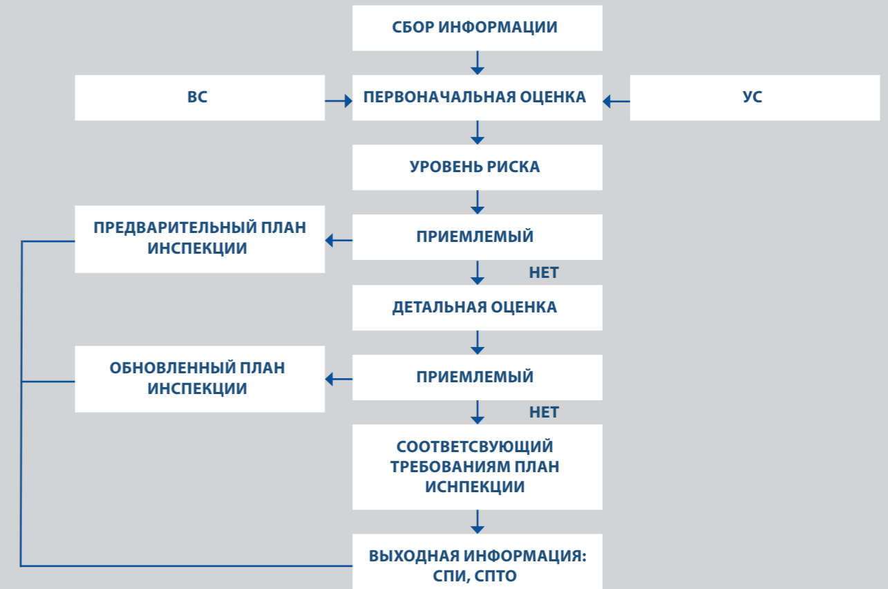
Рисунок 5 - Рабочий процесс подготовки ИБАР подводного оборудования
