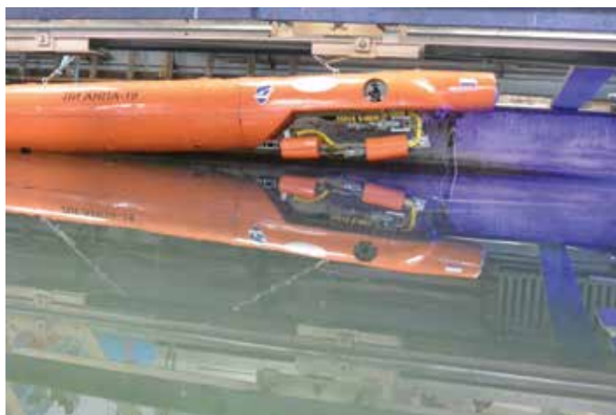
Рисунок 6. Отечественный демонстратор технологии легкого интервенционного АНПА (ЛИ – АНПА) производства АО «НПП ПТ «Океанос»
