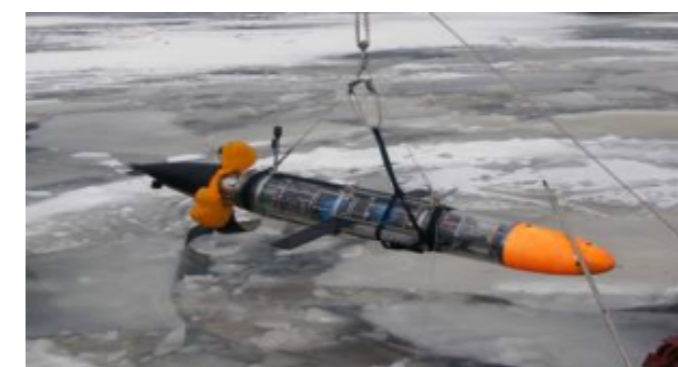
Рисунок 3. Подводный глайдер совместной разработки СПбГМТУ и АО «НПП ПТ «Океанос»
