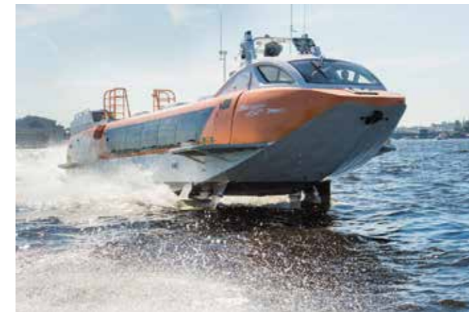
Речное мелкосидящее пассажирское судно на подводных крыльях «Валдай 45Р» проекта 23180. Предназначено для скоростных перевозок в светлое время суток. Оборудовано системами управления Иртыш 7СУ6-10.7 производства ООО ПЗ «РИАТОМ»
