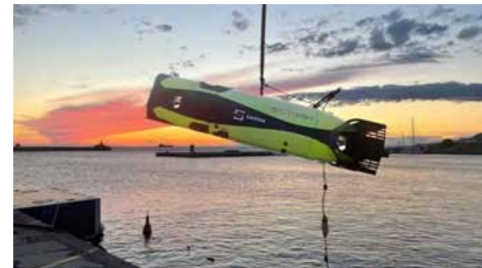
Рисунок 2. Подводный резидентный НПА FlatFish в процессе опытной эксплуатации у побережья Бразилии
