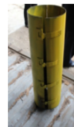
Предварительная ремонтная гильза
