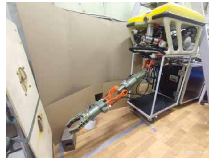
Рисунок 10. Процесс отладки сопряженной работы манипуляторного комплекса и системы технического зрения для автономного выполнения работ с макетом панели ПДК на стенде 1 этапа наземной отработки
