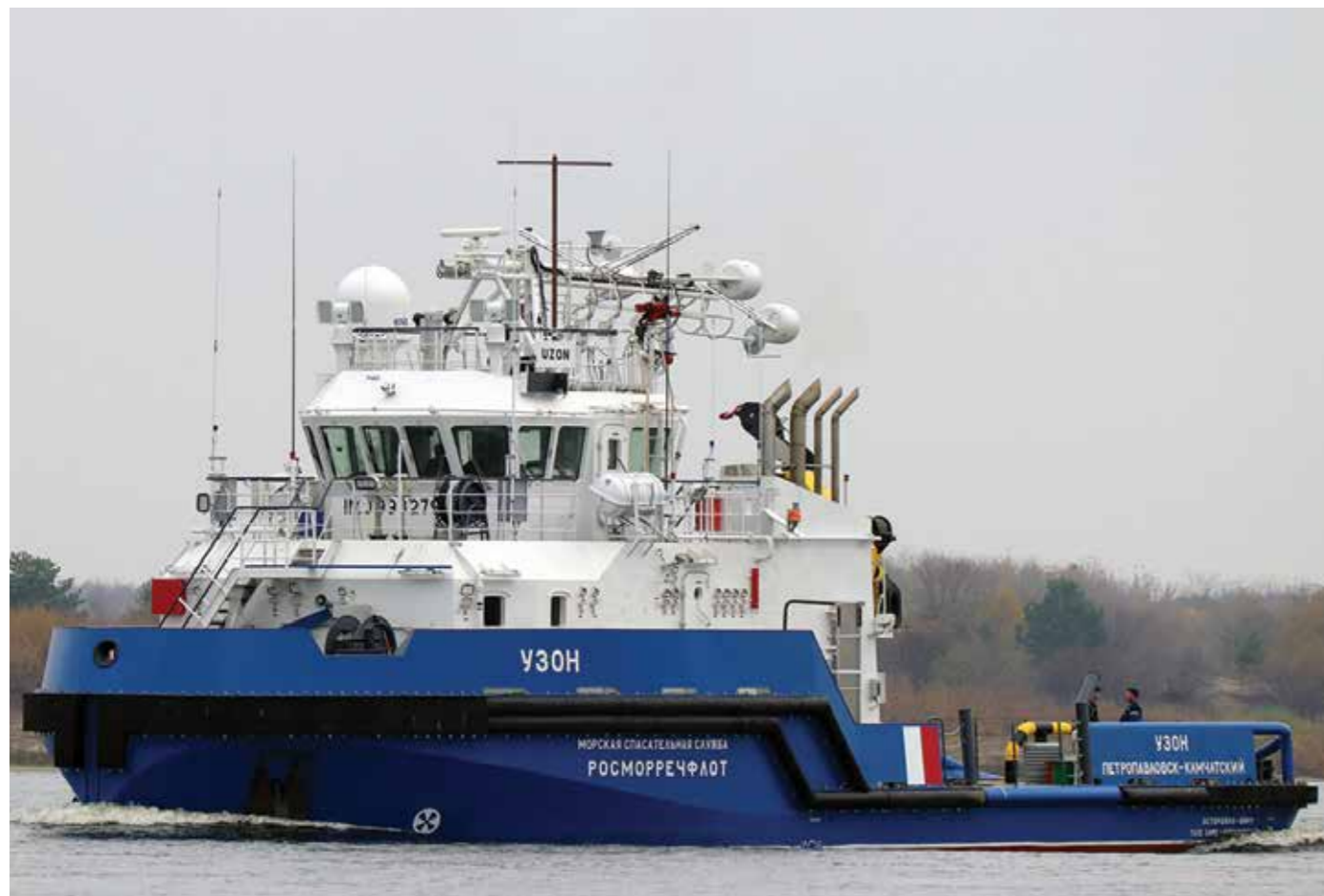
Буксир «Узон» проекта NE025. Системы ДАУ «Корвет», а также дизель-генераторы с системами управления 7СУ6, производства ООО ПЗ «РИАТОМ», поставлены на суда компанией БалтПроект
