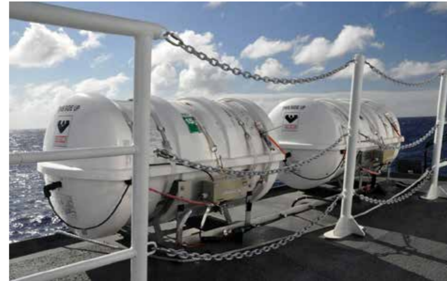
Плот установленный на судне
