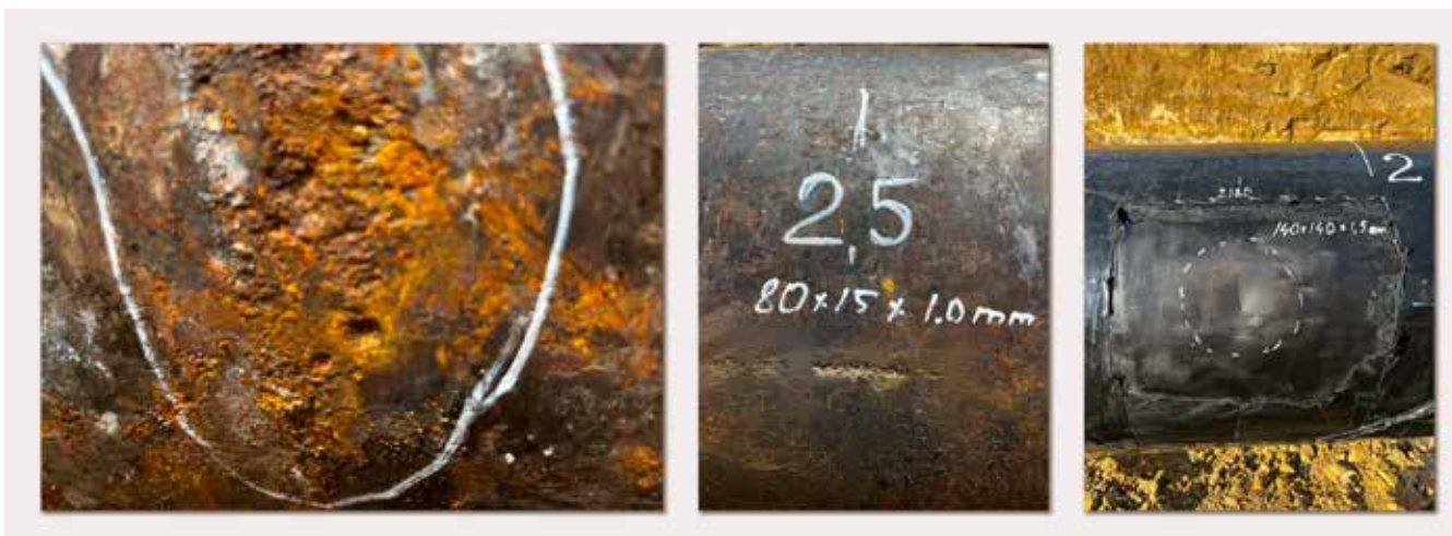
Рис. 4 Аномалии кольцевых напряжений, обусловленные дефектами различной природы на водоводе
