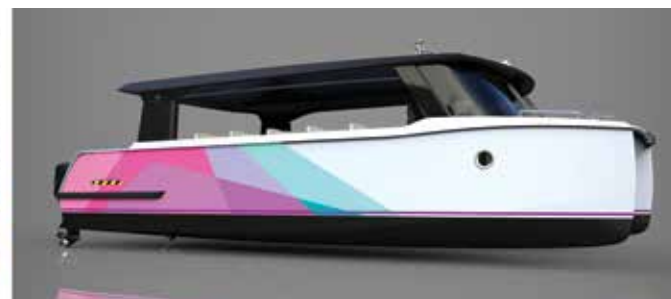
Рис.4 - Проект «Пингвин» - 12-метровый высокоскоростной катамаран на 36 человек, транспортируемый в контейнерах
