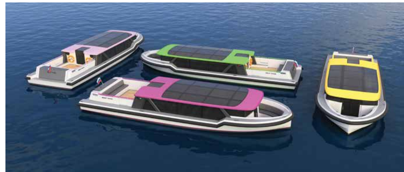
Рис.2 - Малое пассажирское судно пр. SP15 для каналов Санкт-Петербурга (проект КБ АНМК, класс РС).
