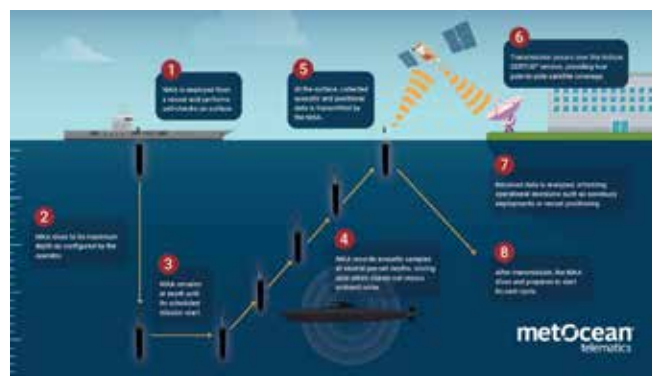
Рис.3 Схема применения системы NiKA
