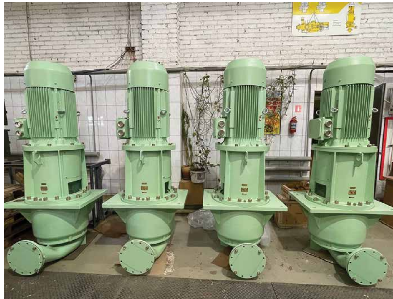
Главные конденсатные электронасосы усовершенствованной конструкции для головного атомного ледокола РОССИЯ проекта № 10510 «Лидер»
