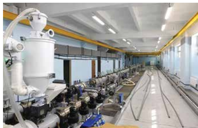
Рис. 1. Установка по автоматизированному выпуску полипропиленовых труб
