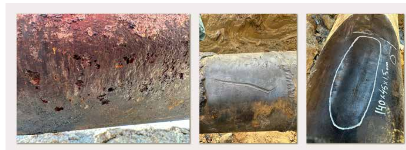
Рис.3. Коррозия и механические дефекты подтверждены в шурфе, вскрытом по результатам МТМ-Градиент как аномалия, обусловленная изменением кольцевых механических напряжений
