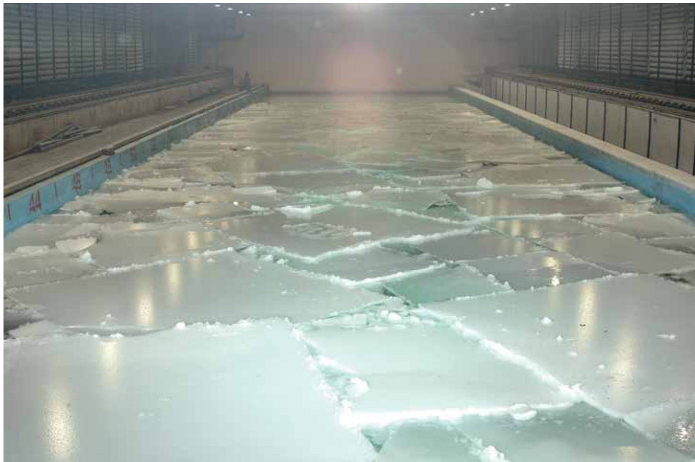
Рис. 3а. Моделированные ледяные образования сплоченный крупнобитый лед.
