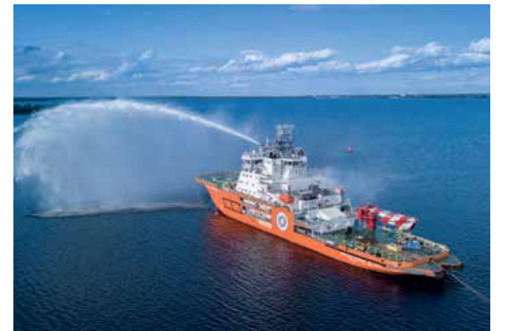
Испытания системы пожаротушения на ледоколе «Санников»
