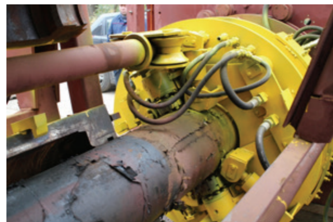
Рисунок 2 – Механизм зачистки трубы
