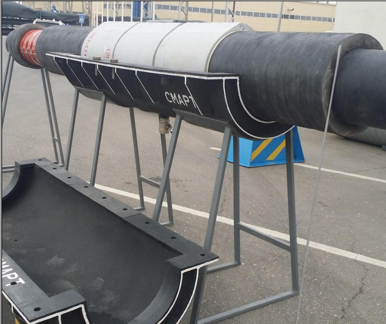
1. Дефектная секция трубопровода усиливается муфтами УКМТ поверх бетонной футеровки по всей поверхности.
