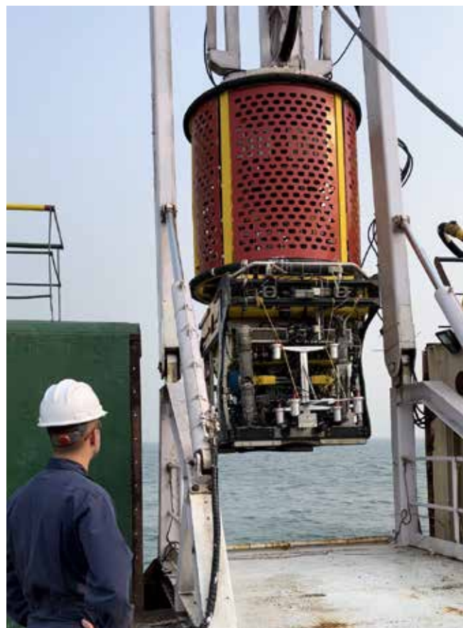
Рис. 1 - Применение магнитометра «КОРД» на ТНПА рабочего класса
