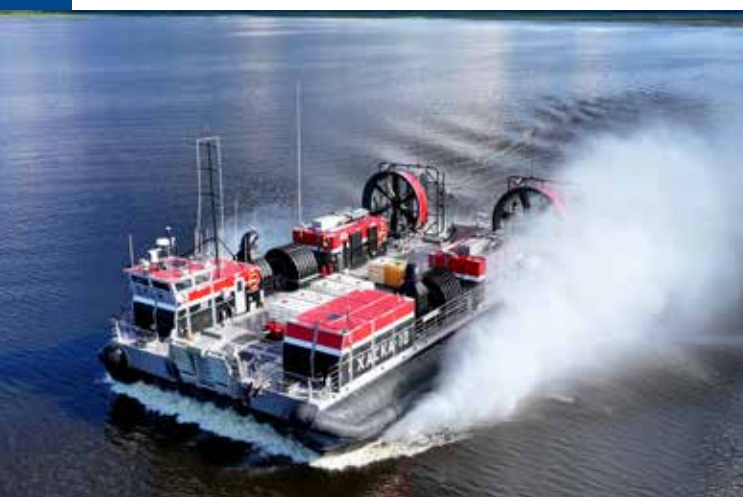
Судно на воздушной подушке с гибкими скегами проекта 03660 «Хаска-10» на ходовых испытаниях в акватории Рыбинского водохранилища
