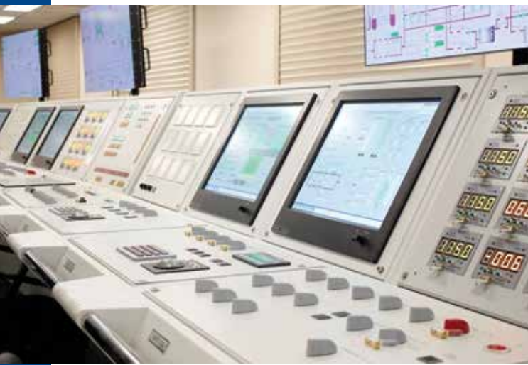
Рисунок 4 – Полномасштабный и функциональный тренажеры для подготовки оперативного персонала универсального атомного ледокола проекта 22220
