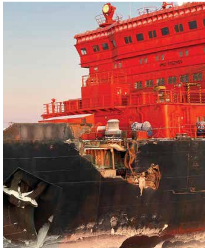
Рисунок 3 – Повреждение обшивки корпуса атомного ледокола «50 лет Победы» при околке льда в Карском море при столкновении с сухогрузом Yamal krechet
