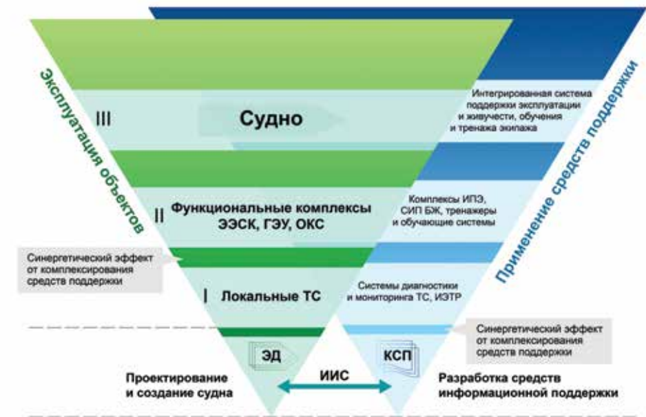
Рисунок 1 – Возникновение синергетического эффекта при комплексной разработке и системном использовании средств информационной поддержки эксплуатации и борьбы за живучесть судна арктической зоны
