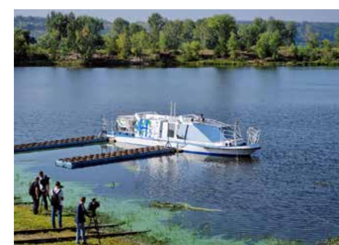
Уникальное прогульно-экскурсионное судно с энергетической установкой на водородных топливных элементах
