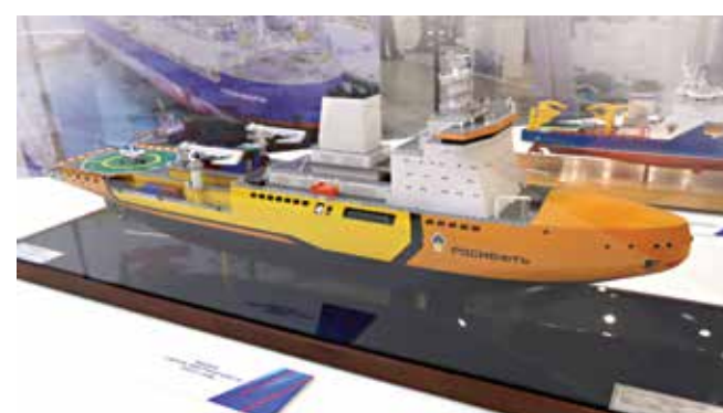
Ледокол с дизель-электрической главной энергоустановкой проекта 24500
