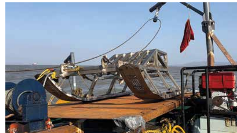
Рис. 2 - Применение буксируемого подводного аппарата типа «SANKI»
