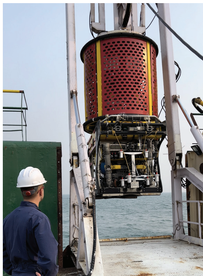
Рис. 1 - Применение магнитометра «КОРД» на ТНПА рабочего класса
