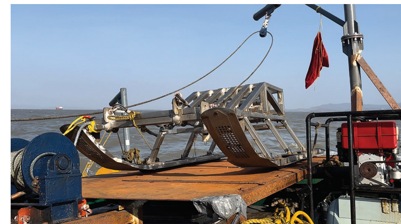
Рис. 2 - Применение буксируемого подводного аппарата типа «SANKI»
