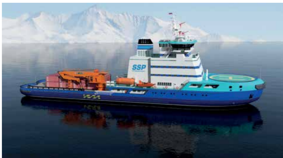
Вспомогательный ледокол, работающий на сжиженном природном газе
