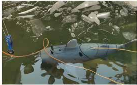
Рисунок 3 – Китайский бионический подводный дрон в виде акулы (доступен на рынке в различных модификациях с 2023 года) (окончание)
