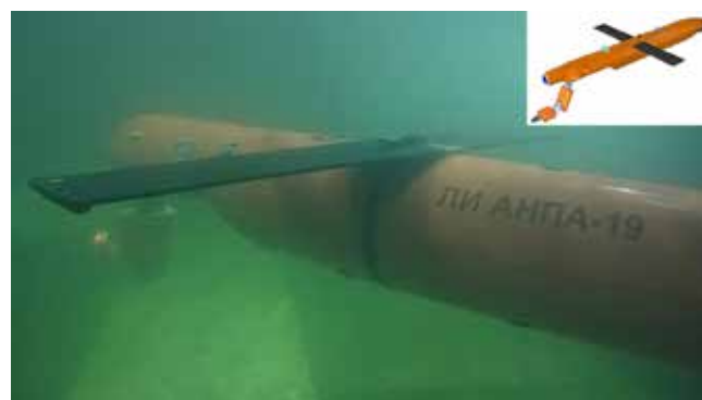
Рисунок 10. Демонстратор технологий ЛИ АНПА в гибридном исполнении «Интервенционный подводный планер – АНПА» с крыльевым блоком «высококоплан» в процессе испытаний комбинированного режима управления АНПА и манипуляторного комплекса в испытательном гидродинамическом бассейне СПбГМТУ в 2019 г.
