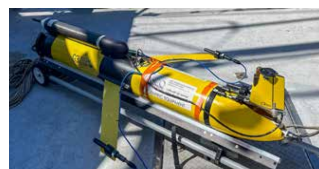
Рисунок 3. Подводный глайдер Slocum с установленной системой направленного пассивного акустического мониторинга [11].
