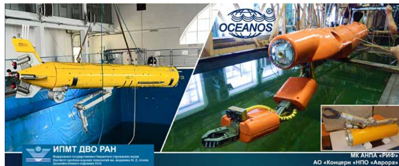
Рисунок 7. АНПА ММТ-3500 с бортовым многозвенным манипулятором (слева), демонстратор технологий ЛИ-АНПА (справа) и МК АНПА «РИФ».
