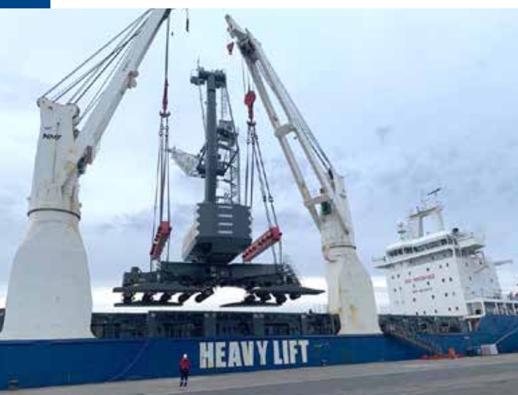
Тяжеловесного перегрузочного оборудования с использованием двух судовых кранов одновременно «спарка».
