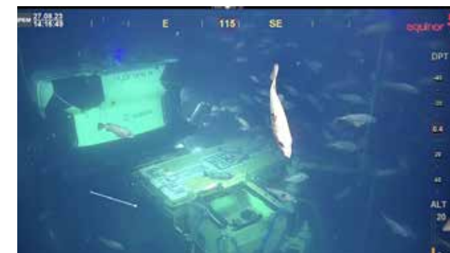
Рисунок 5. Подводный резидентный аппарат Hydrone-R в процессе стыковки с доковой станцией на месторождении Ньюрд.
