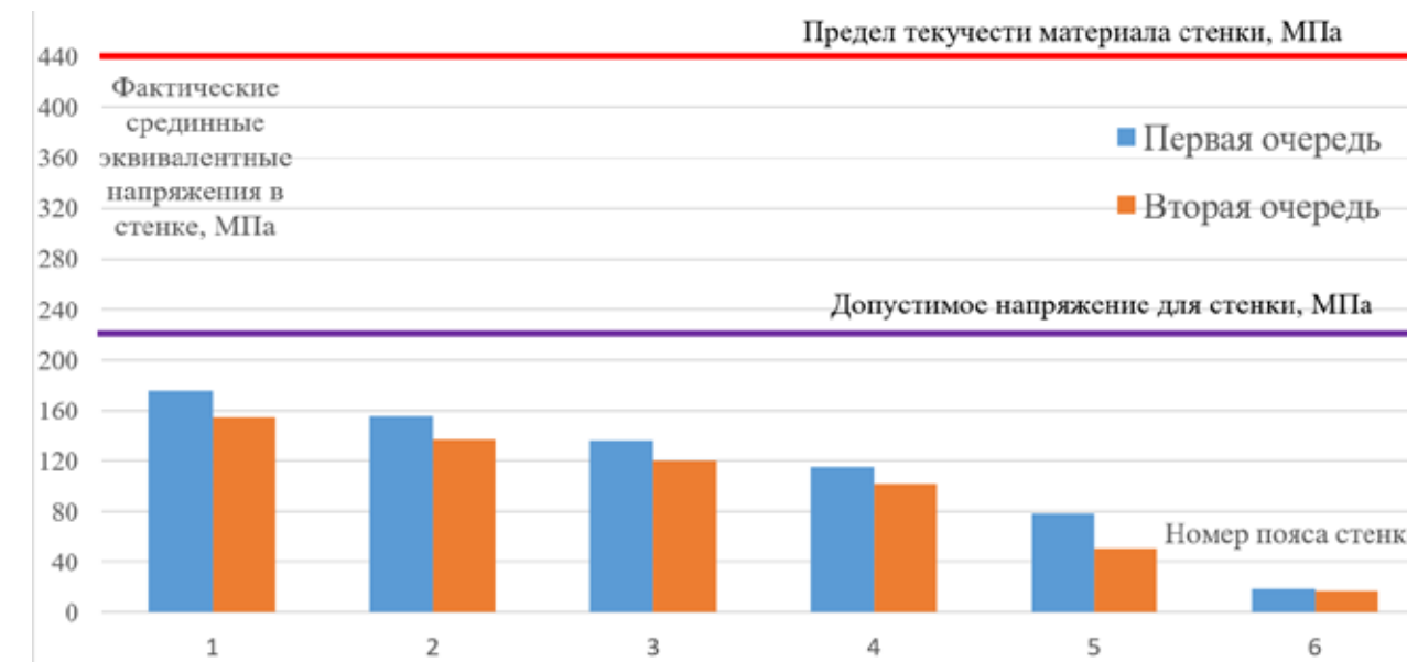
Рисунок 1 – Сравнение напряжений в стенке РВСПК 100 000 разных очередей постройки морского терминала АО «КТК-Р»
