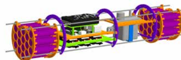
Рисунок 5 – Внешний вид универсального аппаратного отсека подводного дрона НИЯУ МИФИ
