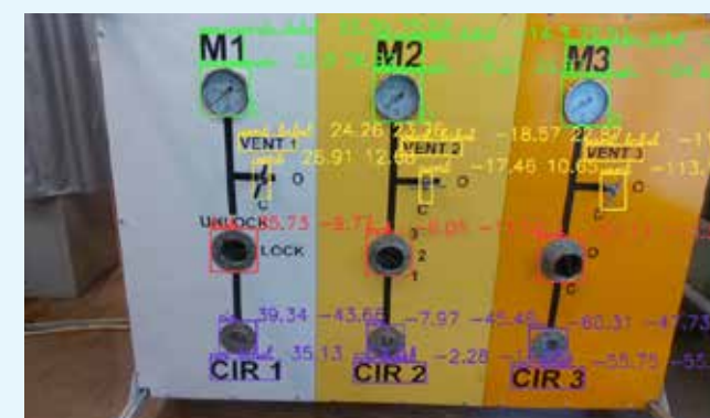
Рисунок 13. Процесс детектирования и оценки состояния рабочих элементов макета панели ПДК.
