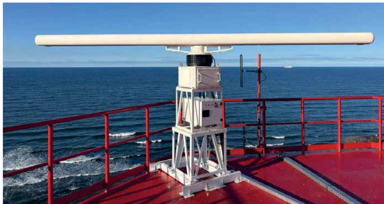
Береговая РЛС "Маяк-С" на опытной эксплуатации, установленная на АРТП-5 в Калининградской области, производства АО НПП «ИНТЭЛ»
