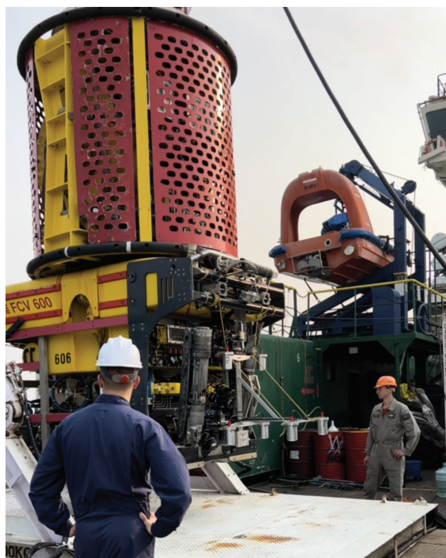
Рис. 4 ТНПА с магнитометром КОРД
