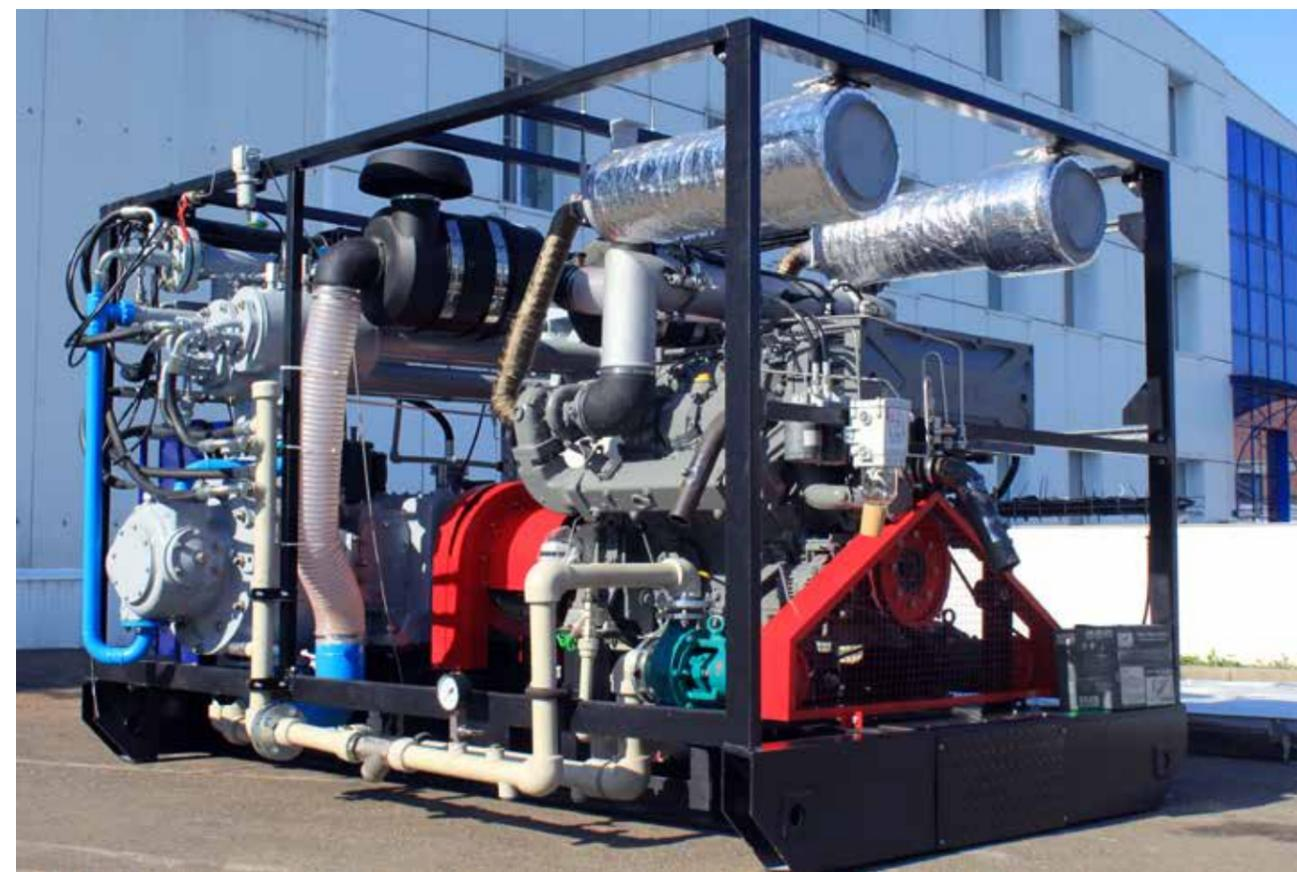
Морская воздушная компрессорная установка ККЗ на открытой раме, готова к монтажу на нижней палубе геологоразведочного судна ОАО «Дальморнефтегеофизика»
