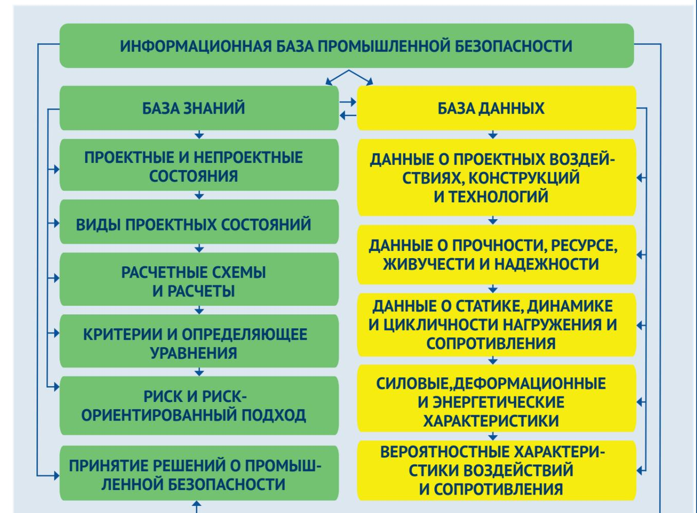
Рис. 3. Принципиальная структурная схема информационной базы комплексной безопасности
