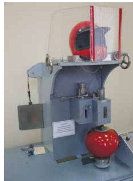
Испытание шлемов для мотоциклистов
