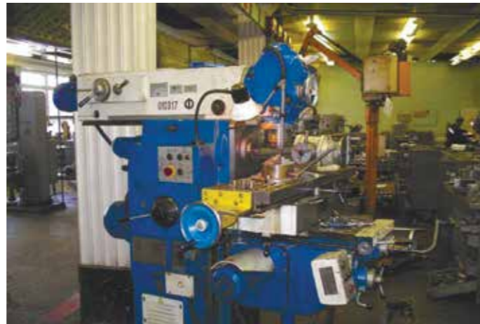
Универсальный станок в цехе № 11 судовой арматуры с ручным, пневмо- и гидроприводами
