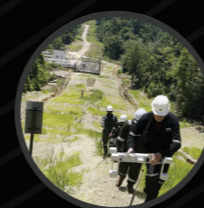
Инспекция сухопутных участков выполняется операторами при движении вдоль оси трубы
