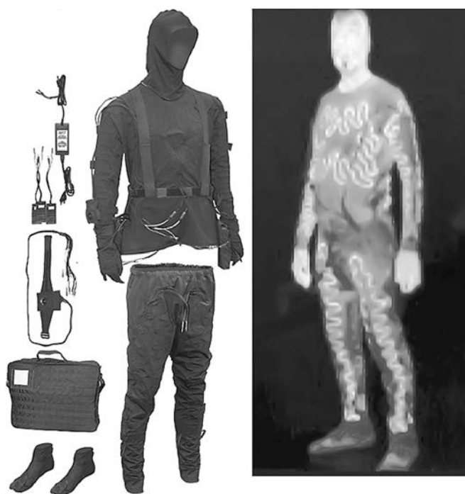
Рис. 1. Внешний вид и температурное поле костюма электрообогрева водолаза
