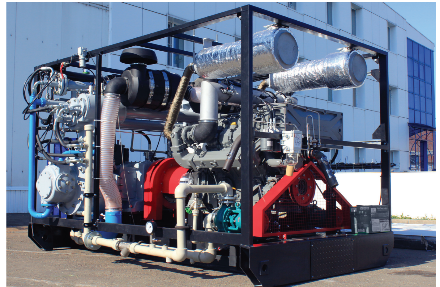
Морская воздушная компрессорная установка ККЗ на открытой раме, готова к монтажу на нижней палубе геологоразведочного судна ОАО «Дальморнефтегеофизика»
