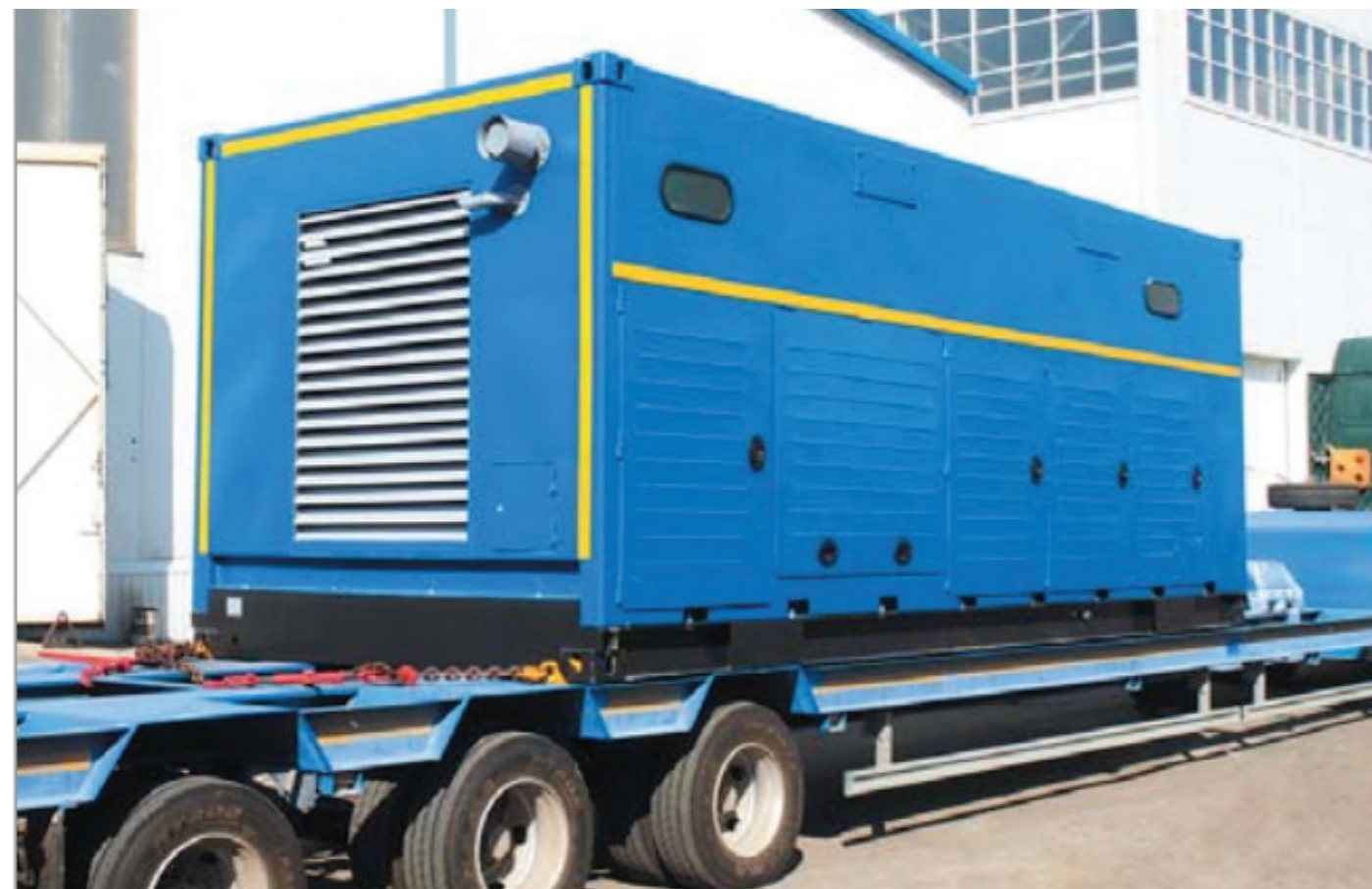
Морская воздушная компрессорная станция ТГА-10/220 в специальном морском модуле, готова к размещению на верхней палубе геологоразведочного судна ОАО «МАГЭ»
