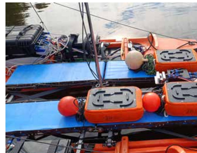
Рисунок 6. Донные автоматические станции выложены на конвейерах для постановки в ходе многофункциональной миссии и процесс постановки донной автоматической станции с МНС «Лощман» по результатам получения сонограммы ГБО в режиме реального времени в районе выявленного техногенного объекта (АНПА рис. 4) в течении одной миссии
