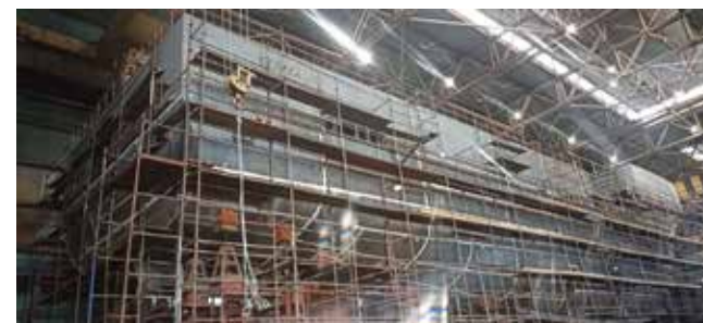
Формирование корпуса краболова-живовоза «Белуха» проекта 6135 идет полным ходом на «Верфи братьев Нобель»
