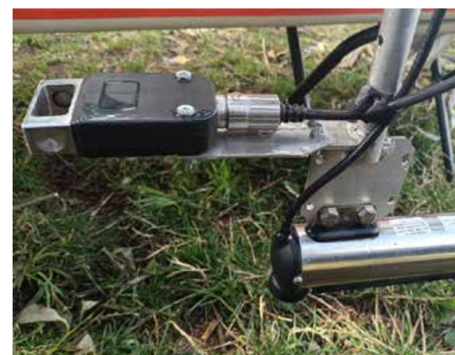
Рисунок 3. Прямой измеритель скорости звука и комплекс однолучевого эхолота и гидролокатора бокового обзора (ГБО) ООО «Экран» и доплеровский лазер СПбГМТУ, использованные в ходе отработки технико-технологических решений применения МРТК
