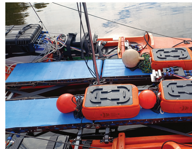
Рисунок 6. Донные автоматические станции выложены на конвейерах для постановки в ходе многофункциональной миссии и процесс постановки донной автоматической станции с МНС «Лоцман» по результатам получения сонограммы ГБО в режиме реального времени в районе выявленного техногенного объекта (АНПА рис. 4) в течении одной миссии
