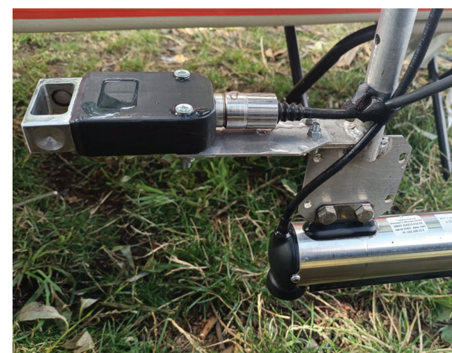
Рисунок 3. Прямой измеритель скорости звука и комплекс однолучевого эхолота и гидролокатора бокового обзора (ГБО) ООО «Экран» и доплеровский лазер СПбГМУ, использованные в ходе отработки технико-технологических решений применения МРТК
