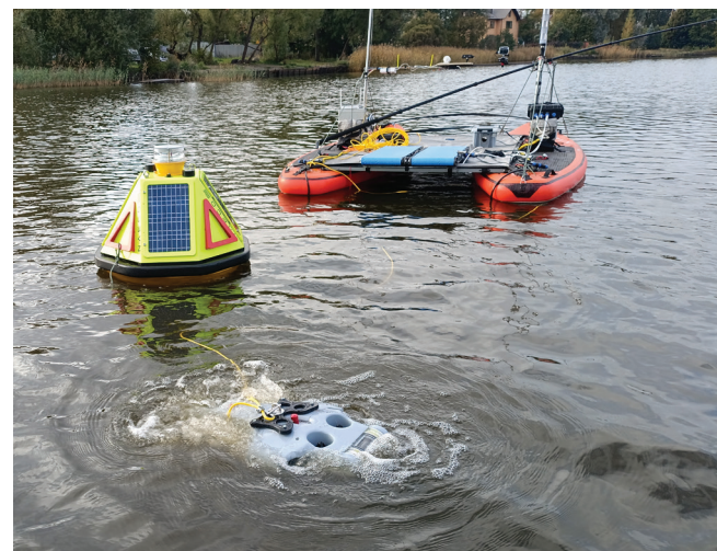
Рисунок 4. Сонограммы ГБО ООО «Экран» с АНПА на грунте и донной сейсмокосою (диаметр 20 мм, грунт – ил) полученные в ходе отработок в полигоне АО «Концерн «Океанприбор» и выставленный с МНС «Лоцман» образца 2025 г. многопараметрический мониторинговый буй «NAECO» в ходе осмотра спущенным с МНС «Лоцман» ТНПА СПбГМТУ
