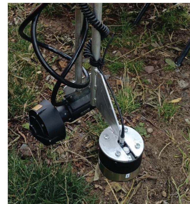
Рисунок 3. Прямой измеритель скорости звука и комплекс однолучевого эхолота и гидролокатора бокового обзора (ГБО) ООО «Экран» и доплеровский лазер СПбГМУ, использованные в ходе отработки технико-технологических решений применения МРТК
