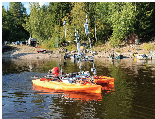
Рисунок 5. МНС «Лоцман» облика 2026 г. выходит на гидролокационное обследование с последующей постановкой сетевых гидроакустических модемов ООО «Латена» (уложены на конвейерах) при отработке многофункциональной миссии
