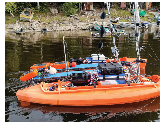
Рисунок 6. Донные автоматические станции выложены на конвейерах для постановки в ходе многофункциональной миссии и процесс постановки донной автоматической станции с МНС «Лоцман» по результатам получения сонограммы ГБО в режиме реального времени в районе выявленного техногенного объекта (АНПА рис. 4) в течении одной миссии
