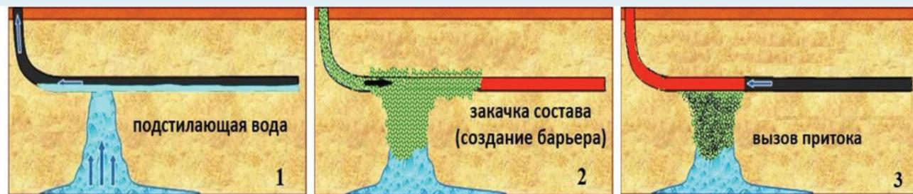
Применение технологий ограничения водопритока в скважинах с горизонтальным окончанием.
