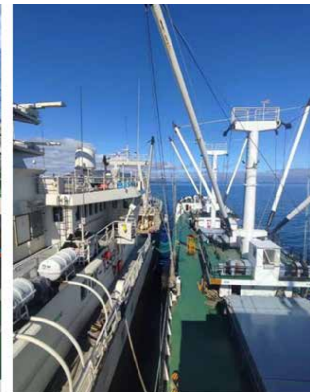
Перегруз рыбопродукции в открытом море с борта траулера на транспортный рефрижератор
