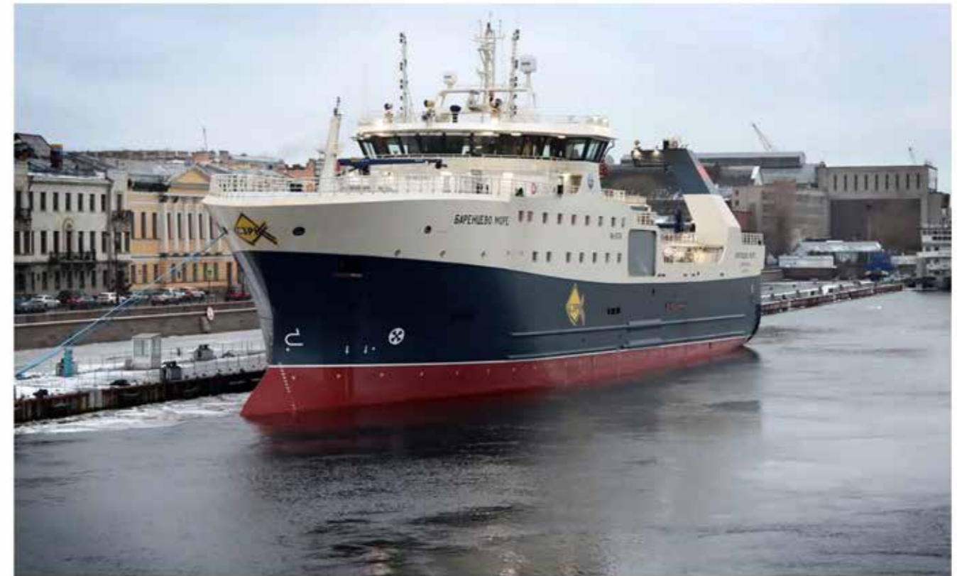
Траулер проекта КМТ-01 «Баренцево море» ежесуточный вылов 160 - 170 тн рыбы-сырца, заморозка - 110 тн в сутки, рыбомучная установка переработка отходов производства - 60 тн в сутки в рыбную муку (8 тн) и рыбий жир (2 тн)
