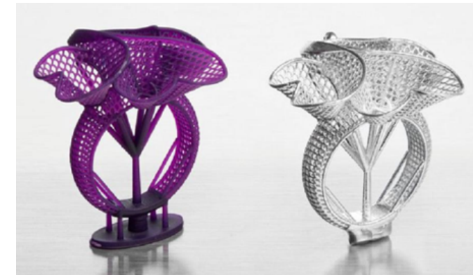
Рис. 2 – Мастер-модель, спроектированная по технологии 3D-моделирования ювелирных изделий, и распечатанная на 3D-принтере (слева), и готовое изделие (справа)
