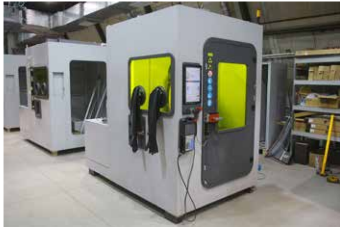
Установка прямого лазерного выращивания института лазерных и сварочных технологий СПбГМТУ
