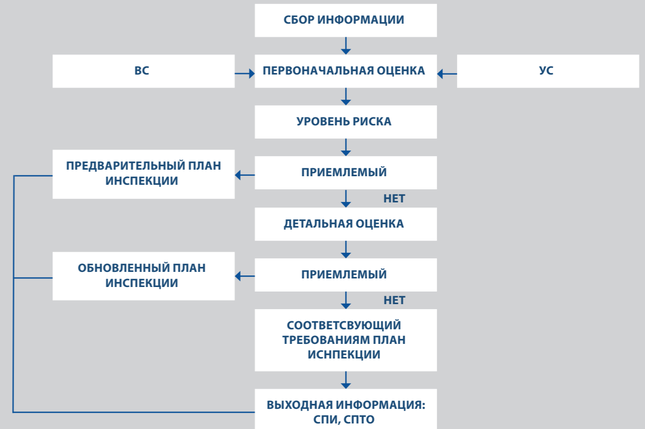
Рисунок 5 - Рабочий процесс подготовки ИБАР подводного оборудования
