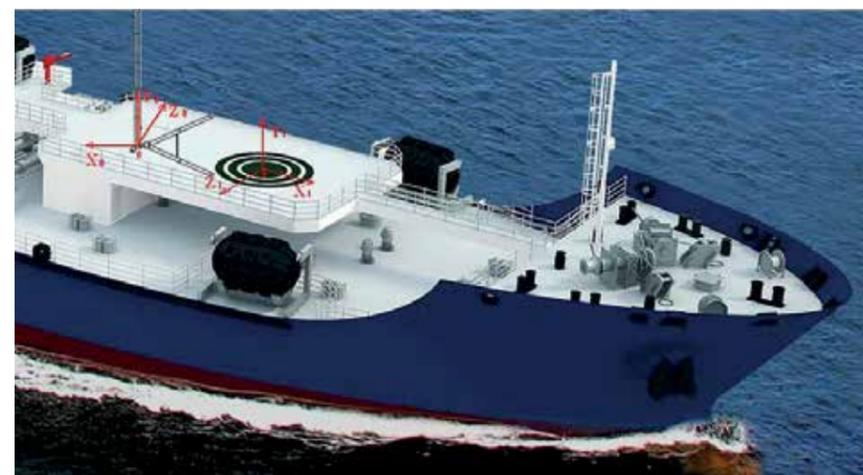
пользовался современным пакет вычислительной гидродинамики OpenFOAM. Расчеты производились только для надводной части корпуса судна. Для выполнения расчетов была адаптирована трехмерная модель судна со всеми устройствами и выступающими частями.
