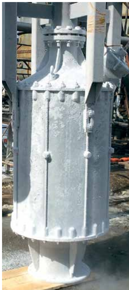
Насос НСПГ 900–120 после натурных испытаний
