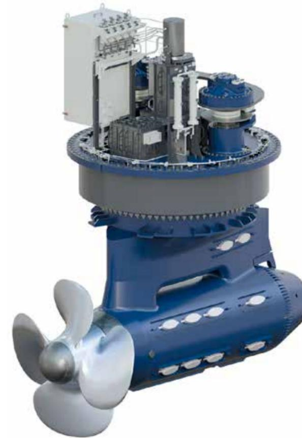
3. В настоящее время ПГ «КОНАР» выполняет ОКР Шифр «Замещение-ВПК Icebreaker», в ходе которого разрабатывается типоряд электрических винторулевых колонок (ЭВРК) мощностью до 4 МВт и ледовым классом Icebreaker7. В рамках ОКР предусмотрено производство опытного образца. Разработка РКД на типоряд (5 изделий) завершена, одобрение РКД РМРС в 4 квартале 2025 г.
