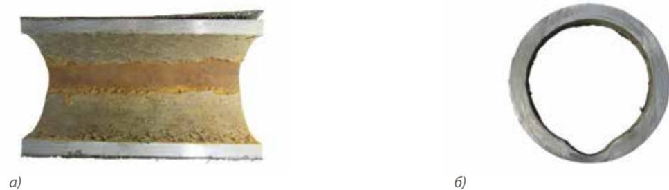
Рис. 3 Ручейковая коррозия металла трубопровода Ø114x12 мм после 894 суток эксплуатации: а) Внутренняя поверхность; б) Сечение стенки трубопровода
