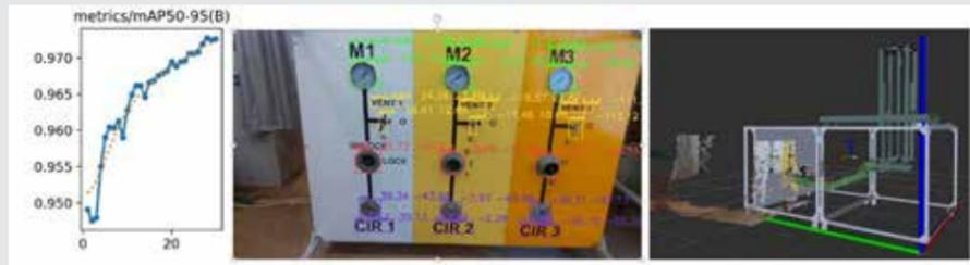
Рисунок 11. Результат метрики точности обучения модели (таP50) и работы ИСТЗ по определению объектов на макете рабочей панели
