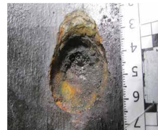
Рис. 5 Коррозионное разрушение трубопровода Ø168x14 мм под действием бактерий коррозионно-опасного нефтяного биоценоза: а) Общий вид; б) Внутренняя поверхность
