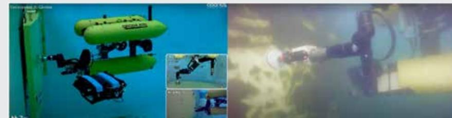
Рисунок 2. Автономное техническое обслуживание подводных объектов с использованием АНПА (слева в испытательном бассейне, справа в процессе работ на морской ветровой платформе ATLANTIS)
