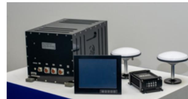
Рис. 3. Аппаратура гироскопического компаса «Альфа-СНС»
