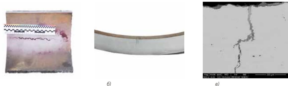
Рис. 7 Сульфидное коррозионное растрескивание под напряжением газопровода  $\varnothing 457 \times 20,62$  мм в процессе эксплуатации: а) Внутренняя поверхность; б) Макроструктура; в) Микроструктура в области распространения трещин. Увеличение  $\times 500$
