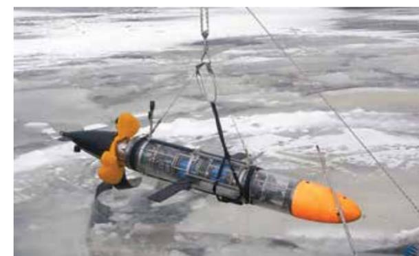
Рис. 2. Подводный глайдер совместной разработки СПбГМТУ и АО «НПП ПТ «Океанос»
