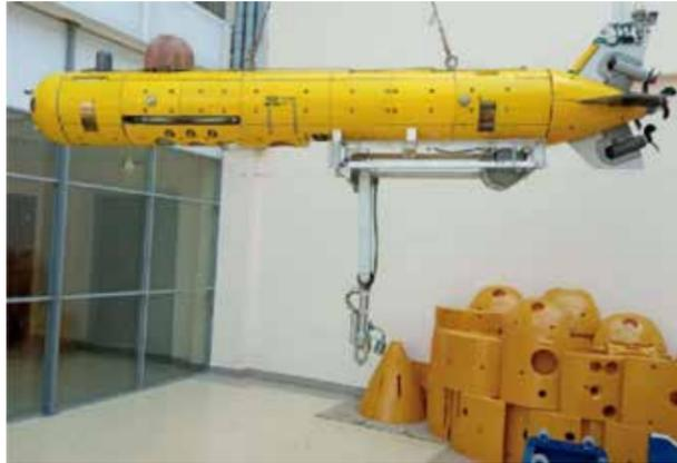
Рисунок 4. АНПА ММТ-3500 с бортовым многозвенным манипуляторным комплексом
