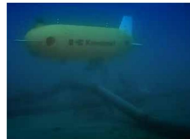
Рисунок 3. АНПА Spice в процесс инспекции имитатора подводного трубопровода Total Energies
