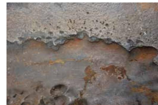
Рис.4 Коррозионно-эрозионный износ трубопровода Ø720x10 мм эксплуатации: а, б) Внутренняя поверхность
