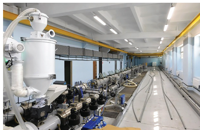
Рис. 1. Установка по автоматизированному выпуску полипропиленовых труб
