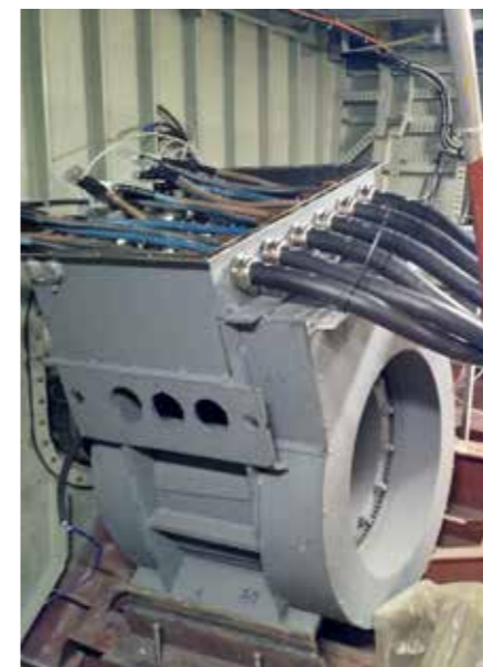
Гребные электродвигатели производства ООО «НПО «СПб» мощность 950 кВт ООО «НПО «СПбЭК»: Клинецвич В.Ю.
