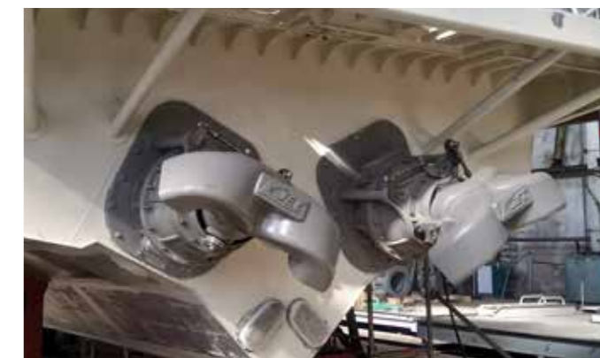
Водометный движитель ВД370Д: максимальная мощность 950 кВт
