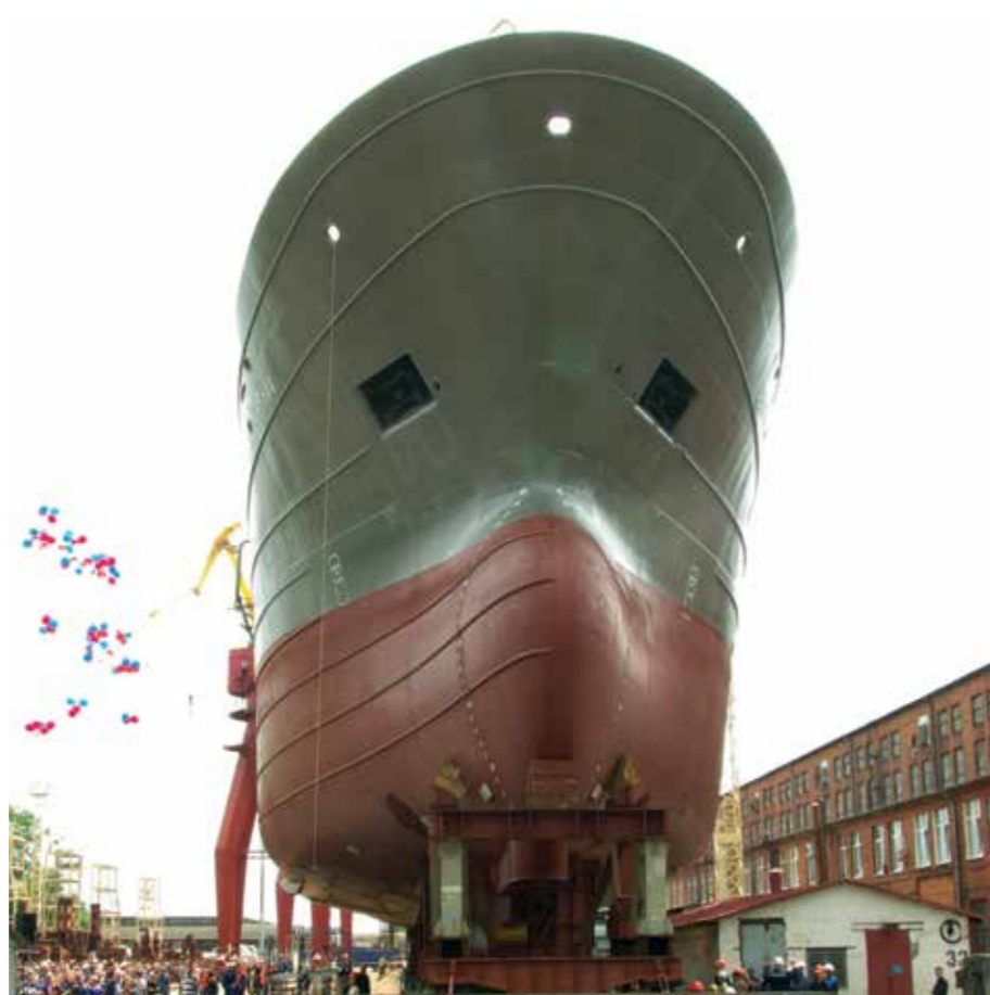
Корпус траулера-сейнера проекта SK-3101R перед спуском на воду
