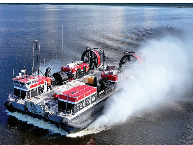
Судно на воздушной подушке с гибкими скегами проекта 03660 «Хаска-10» на ходовых испытаниях в акватории Рыбинского водохранилища
