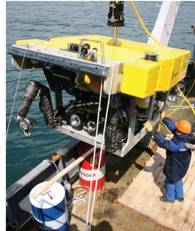
Рис. 2 Типичный представитель ТНПА форм-фактора «кирпич» для донных исследований, как видно, с ним «не разгоняться»
