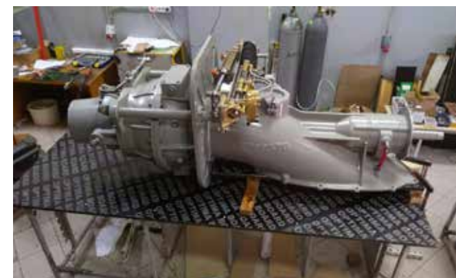
Водометный движитель ВД370D: максимальная мощность 950 кВт
