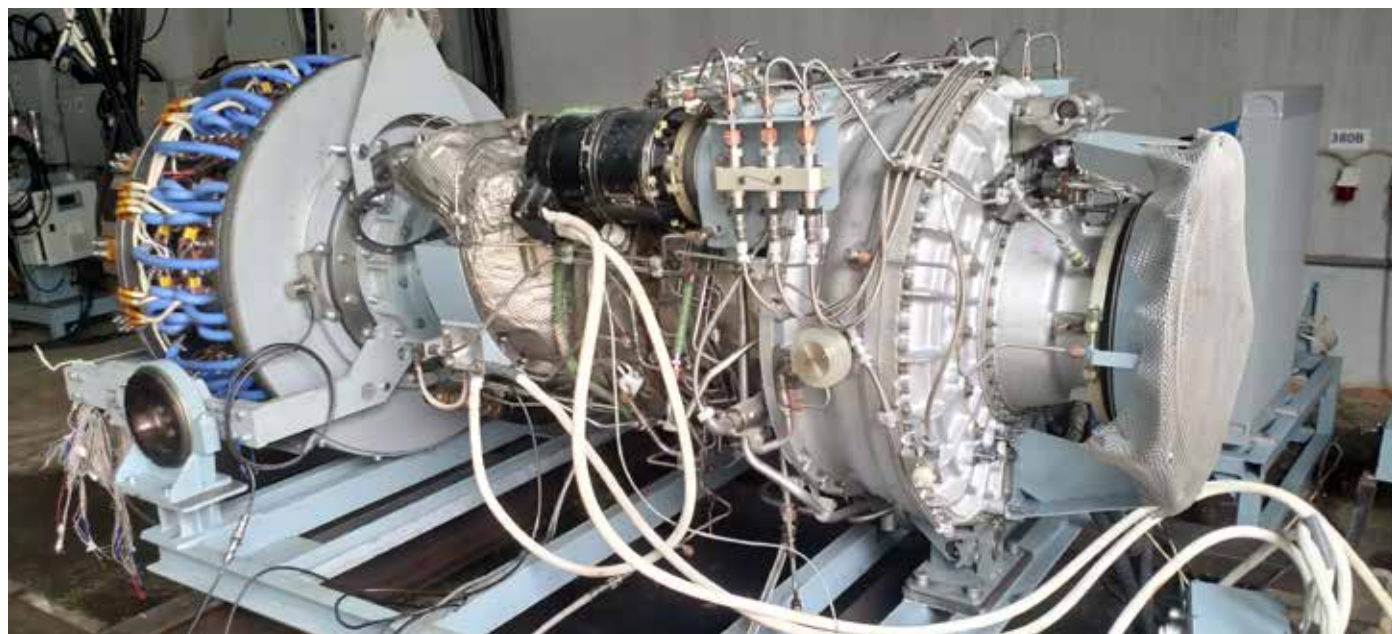
Высокооборотный синхронный турбогенератор с возбуждением от постоянных магнитов СТГ-1-26000 разработки и производства ООО «НПО «СПбЭК»: мощность: 950 кВт. ООО «НПО «СПбЭК»: Клинецвич В.Ю.
