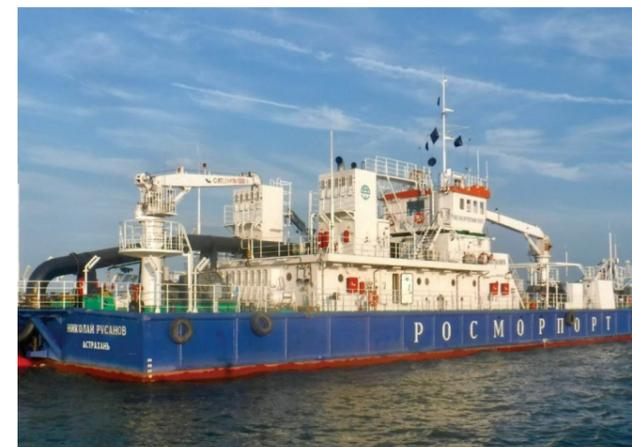
Землесос «Николай Русанов» проекта FPDG3. Оборудован системами АПС 7СУ6 и Омь, системой ДАУ «Корвет» производства ООО ПЗ «РИАТОМ»
