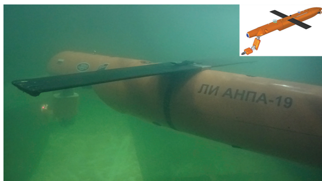
Рисунок 10. Демонстратор технологий ЛИ АНПА в гибридном исполнении «Интервенционный подводный планер – АНПА» с крыльевым блоком «высокоплан» в процессе испытаний комбинированного режима управления АНПА и манипуляторного комплекса в испытательном гидродинамическом бассейне СПбГМТУ в 2019 г.
