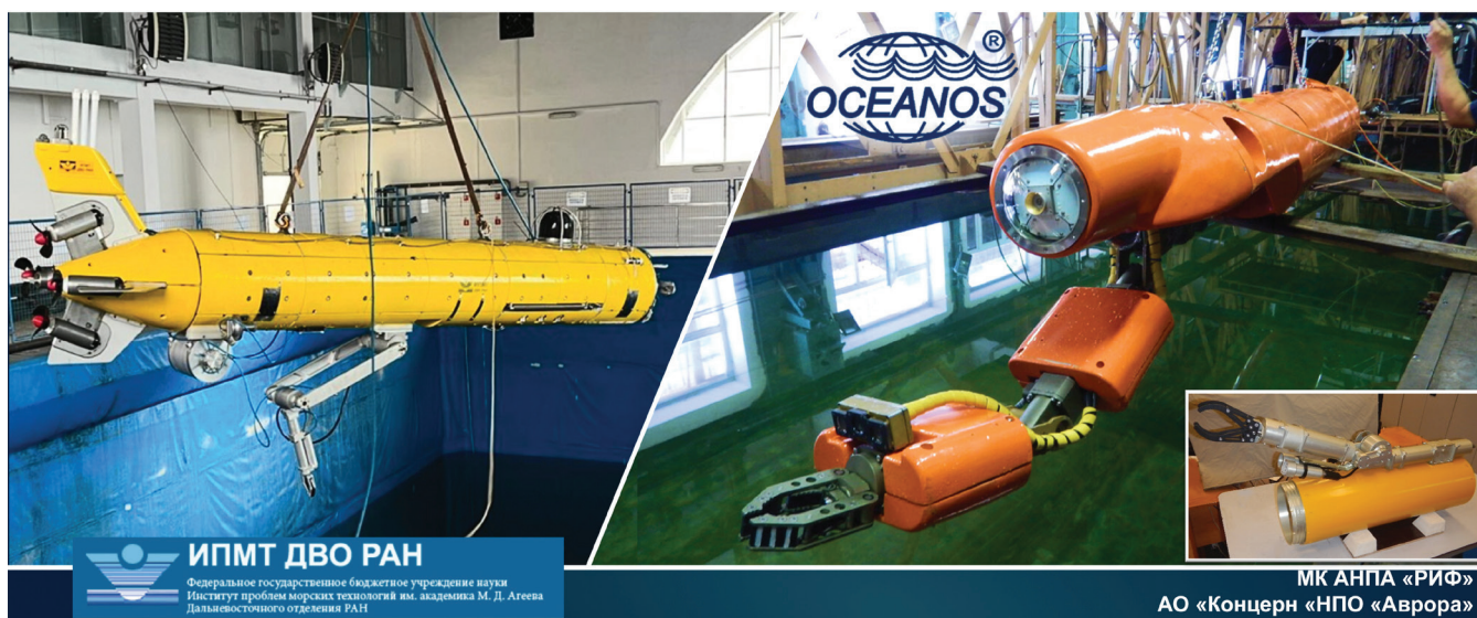
Рисунок 7. АНПА ММТ-3500 с бортовым многозвенным манипуляторным комплексом (слева), демонстратор технологий ЛИ-АНПА (справа) и МК АНПА «РИФ».
