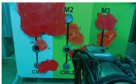
Рисунок 14. Процесс обнаружения областей загрязнения на макете панели ПДК с последующей обработкой и формирования задания по автономной очистке загрязнения.
