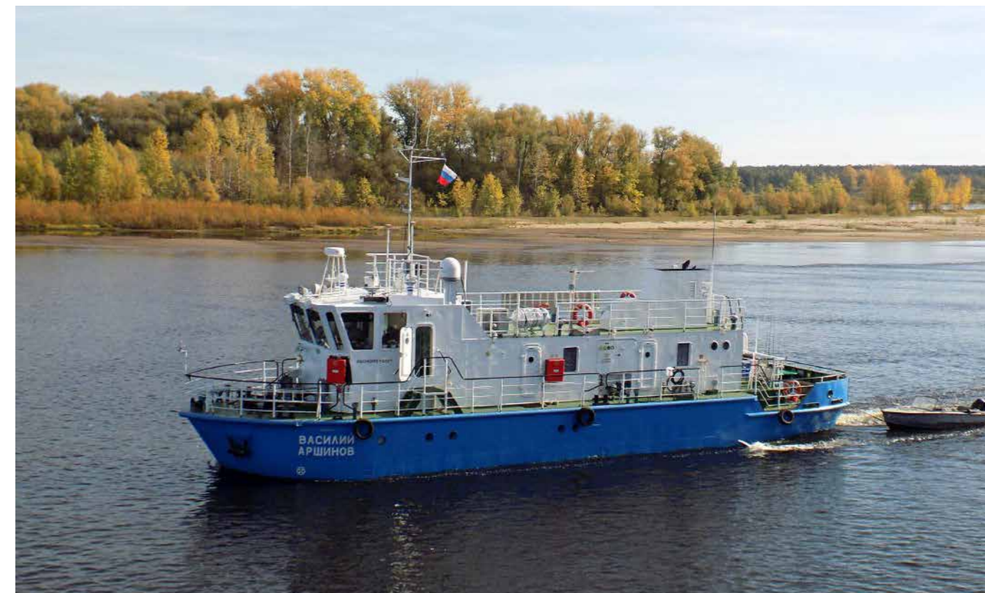
Промерное судно «Василий Аршинов» проекта RDB 66.62. Оборудован системой АПС 7СУ6-11 и системой ДАУ «Корвет» производства ООО ПЗ «РИАТОМ»
