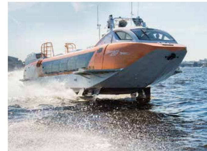
Речное мелкосидящее пассажирское судно на подводных крыльях «Валдай 45Р» проекта 23180. Предназначено для скоростных перевозок в светлое время суток. Оборудовано системами управления Иртыш 7СУ6-10.7 производства ООО ПЗ «РИАТОМ»
